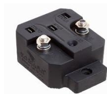
Die Batterierelais (BS) sind leistungsstarke mechanische Kontakte angesteuert von einem Mikroprozessor. Ein BS kann verwendet werden wenn eine System aus zwei Batterien besteht (Starter- und Hilfsbatterie), oder einer Starterbatterie und Gleichstromverbraachern (12V Lampe, usw...), wie zum Beispiel auf Booten oder Camping-Cars.
